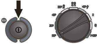
Messgerät einschalten. Den Drehschalter für die Funktionswahl auf die Position **2P** stellen.
