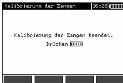
Das Messgerät bestimmte den Korrekturfaktor für die angeschlossenen Zangen. Dieser Faktor wird auch nach dem Ausschalten der Stromversorgung des Messgerätes gespeichert, und zwar bis zur nächsten erfolgreichen Kalibrierung der Zangen.
